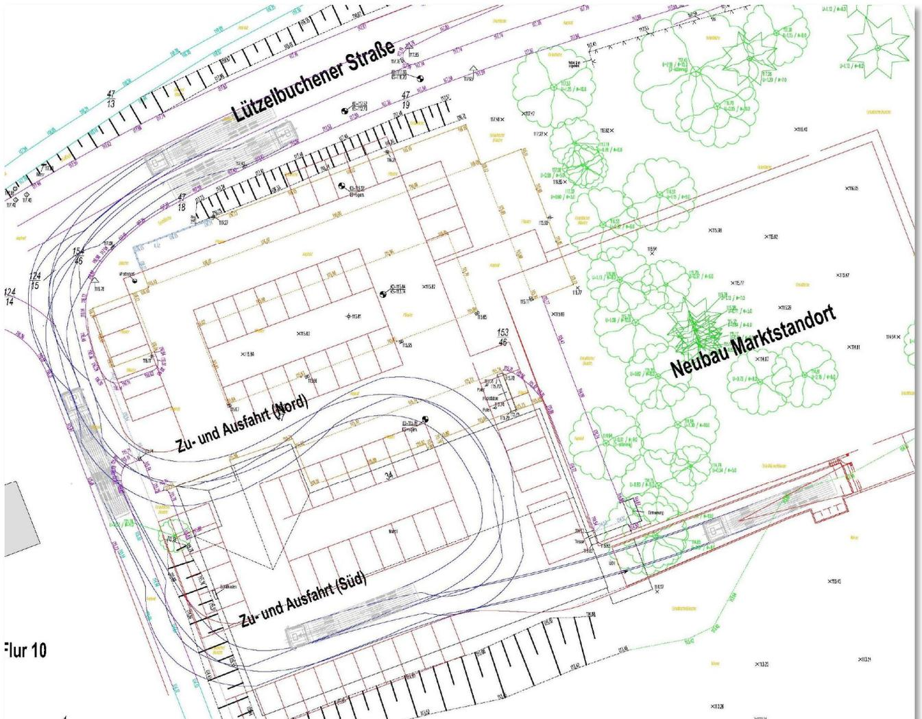
Anhang 1: Prüfung der Erschließungsqualität: Schleppkurvensimulation des Ziel- und Quellverkehrs - Bemessungsfahrzeug 'Sattelzug'
