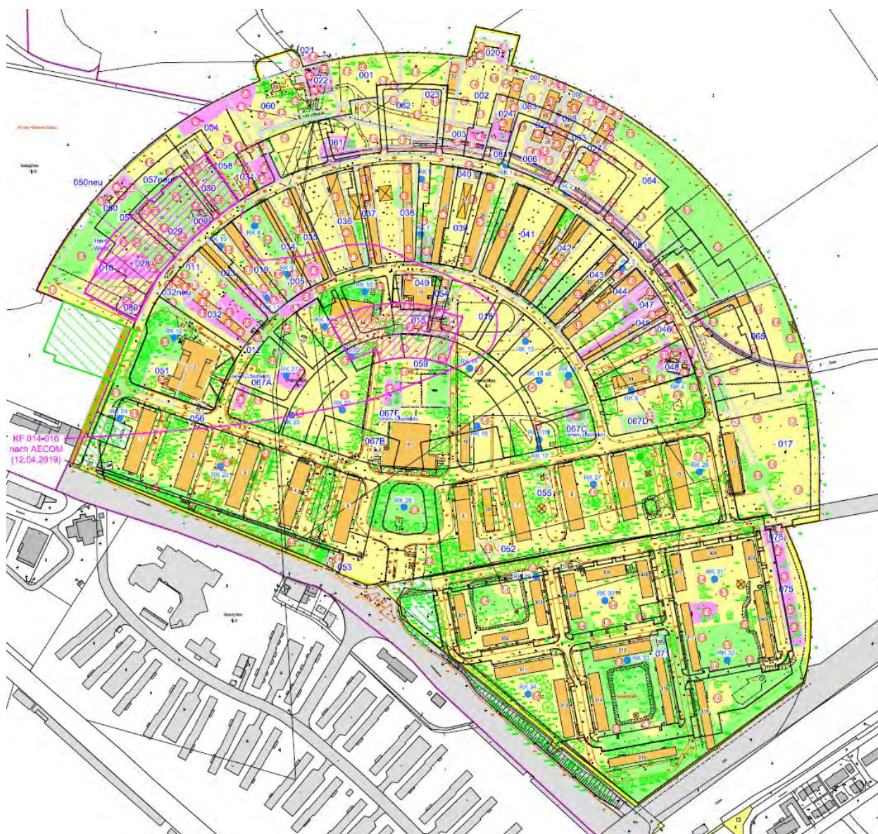
Abb. 17: Kennzeichnung der Auffüllungsbereiche
